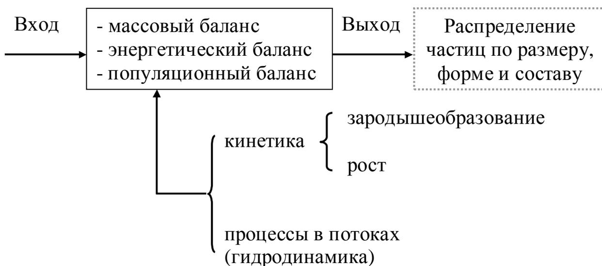
Рис. 1.17. Факторы, определяющие протекание процесса массовой кристаллизации
